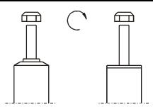
Um eine mögliche Zerstörung des Produktes zu vermeiden, darf zum Lösen und Anziehen der Muttern kein Schlagschraubendreher verwendet werden. Selbstsichernde Muttern dürfen nur einmal verwendet werden!
