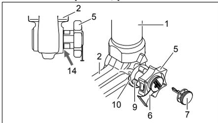
**Odjištěná poloha, odpojeno**
