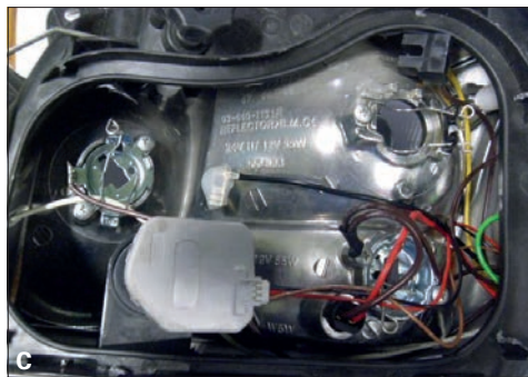
C Den Stellmotor der Originallampe einbauen und dann den Kabelbaum einbauen.
