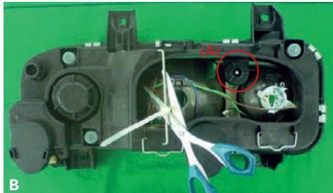
Die Reflektorhalterung herausnehmen (A), dann den Kabelbinder durchschneiden und Kabelbinder sowie Feder herausnehmen.
