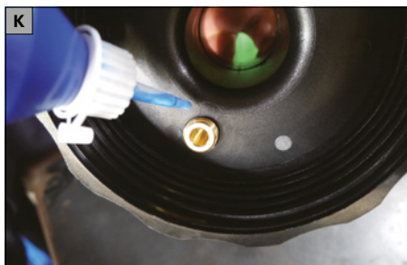
Appliquez du frein-filet sur l'écrou et serrez-le.
