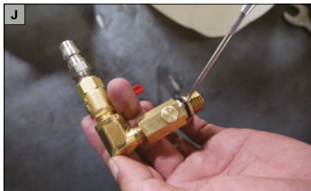
Remplacez le joint torique par un neuf.
