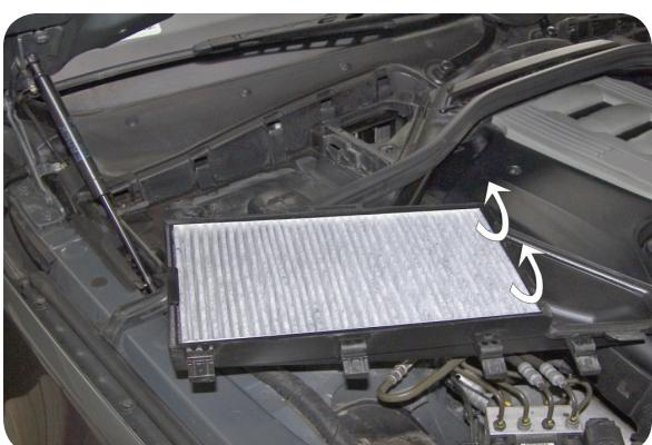
**IT** Rimuovere il filtro con il suo telaio, rimuovere il vecchio filtro dal telaio e installare il nuovo. Ripetere la procedura per il filtro sul lato del guidatore
