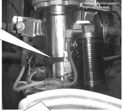
Dämpferleitung in die Stilllegung einstecken. Auf die korrekte Verriegelung des Steckers achten!
