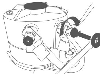
**3.8** Branchez les câbles électriques sur le moteur électrique. Veillez au bon positionnement des câbles et à ce qu'ils ne touchent pas les surfaces chaudes ou abrasives.
