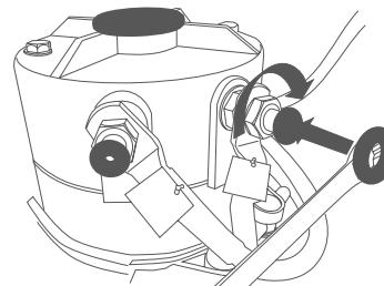
**3.9** Подключите источник питания / минусовой кабель к аккумулятору. Перед запуском системы убедитесь, что аккумулятор полностью заряжен. Проверьте работу всей электросистемы согласно указаниям производителя машины или системы.
