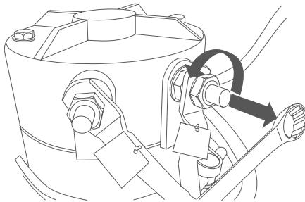
**3.3** В зависимости от назначения электромотор может служить в качестве привода насоса или тягового двигателя. В обоих случаях открутите крепежные болты и отсоедините электромотор от насоса или трансмиссии. Следуйте техническим рекомендациям производителя машины или системы.
