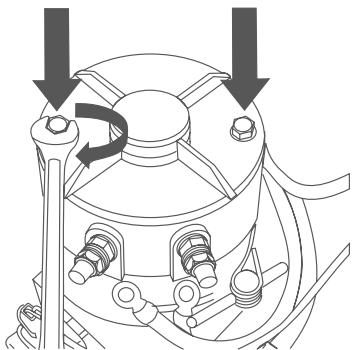
**3.8** قم بتوصيل كابلات التوصيل بالمحرك الكهربائي. يرجى الالتزام بالمسارات الصحيحة للكابلات، والحرص على عدم تلامسها مع الأسطح الساخنة أو الكاشطة.
