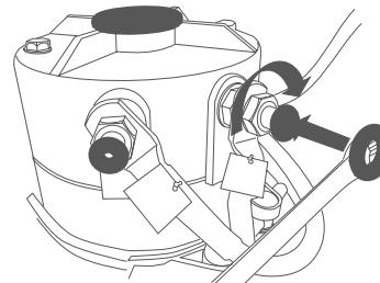
**3.9** Conecte a la batería la alimentación de tensión/el cable negativo de la batería. Antes de arrancar el sistema, asegúrese de que la batería está completamente cargada. Compruebe el funcionamiento de todo el sistema eléctrico según las instrucciones del fabricante de la máquina o el sistema.
