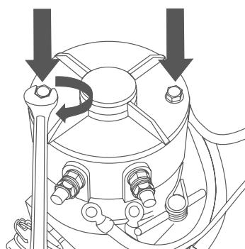
**3.7** Fixez le moteur dans son emplacement. Au besoin, vous trouverez des indications sur les outils nécessaires et le couple de serrage des vis de fixation auprès du constructeur de la machine électrique et/ou du système.
