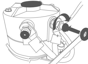
**3.9** Collegare il cavo di corrente negativo alla batteria. Prima di avviare il sistema, assicurarsi che la batteria sia completamente carica. Infine, verificare il funzionamento dell'intero sistema elettrico come da istruzioni del costruttore della macchina o del sistema.
