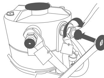
**3.9** Podłączyć przewód akumulatora / źródła napięcia do zacisku minus akumulatora. Przed uruchomieniem systemu sprawdzić, czy akumulator jest całkowicie naładowany. Skontrolować poprawność działania całej instalacji elektrycznej zgodnie z instrukcjami producenta maszyny lub systemu.
