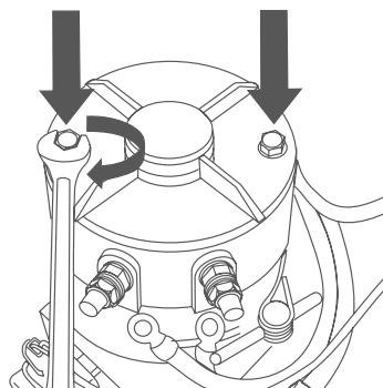
**3.8** Collegare i cavi al motore elettrico. Prestare attenzione alla corretta posa dei cavi, evitando che vengano a contatto con superfici calde o abrasive.
