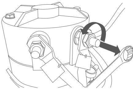
**3.3** يمكن تشغيل المحرك الكهربائي كمحرك ضخم أو محرك جر حسب نوع الاستخدام المطلوب. قم بفك مسامير التثبيت في كلتا الحالتين، وأخرج المحرك الكهربائي من المضخة أو ناقل الحركة. يرجى الالتزام بتعليمات الشركة المصنعة للماكينة أو النظام.
