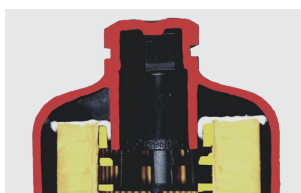
Иллюстрация 2: После завершения монтажа нетканый материал (белого цвета) будет так зажат между внутренней обечайкой (желтого цвета) и стояком (красного цвета), что возникнет полноценное герметичное соединение
