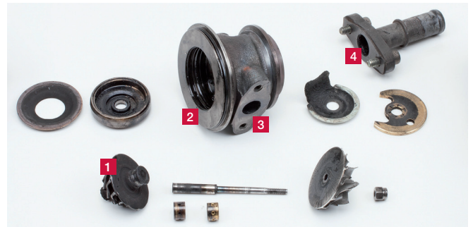
Figura 1: Fig. 1: Cuando el DPF está saturado, los gases de escape pasan a través del turbocompresor; desde la rueda de la turbina (1) a la carcasa del cojinete (2) y a través de la salida de aceite (3) al conducto de retorno (4)
