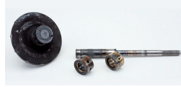
Resim 2: Radyal yatakların yetersiz yağlanması nedeniyle kırılmış rotor mili
