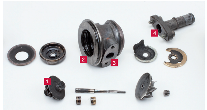
Resim 1: Doymuş bir DPF'de egzoz gazları turboşarj içerisinden geçen yolu izler; türbin çarkından (1) yatak muhafazasına (2) ve oradan yağ çıkışı (3) içerisinden geri dönüş hattına (4)
