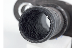
Resim 3: İçeri giren egzoz gazları nedeniyle kurumlanan yağ geri dönüş hattı.
