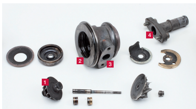
Ilustracja 1: W przypadku przeciążonego filtra DPF spaliny przechodzą przez turbosprężarkę; od wirnika turbiny (1) do obudowy łożyska (2) i dalej przez spust oleju (3) do przewodu powrotnego (4)
