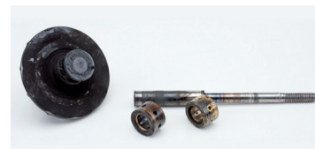
Figure 2: Arbre de rotor cassé en raison d'une lubrification insuffisante du palier radial
