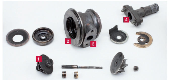
Εικόνα 1: Με κορεσμένο DPF, τα καυσαέρια ακολουθούν τη διαδρομή μέσω του στροβιλοσυμπιεστή. Από τον στρόβιλο (1) στο περίβλημα εδράνου (2) και μέσω του στομίου εκροής λαδιού (3) στον αγωγό επιστροφής (4)
