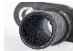
Ilustracja 3: Przewód powrotny oleju pokryty nagarem wskutek wnikania spalin
