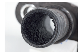
Figure 3: Résidus de calamine dans le retour d'huile suite au passage des gaz d'échappement
