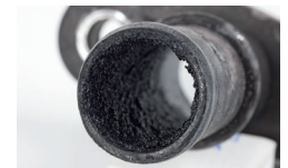
Εικόνα 3: Εξανθρακωμένος αγωγός επιστροφής λαδιού λόγω εισχωρούμενων καυσαερίων
