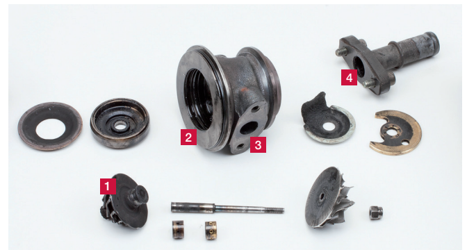
Figure 1: Passage des gaz d'échappement à travers le turbocompresseur en cas de filtre saturé : de la roue de turbine (1) dans le carter de palier (2), puis par la vidange d'huile (3) dans le retour d'huile (4)
