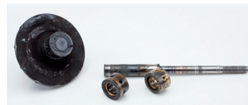
Εικόνα 2: Σπασμένος άξονας ρότορα λόγω ελλιπούς λίπανσης των ακτινικών εδράνων
