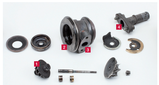
Abbildung 1: Bei gesättigtem DPF nehmen die Abgase den Weg durch den Turbolader; vom Turbinenrad (1) in das Lagergehäuse (2) und durch den Ölablauf (3) in die Rücklaufleitung (4)
