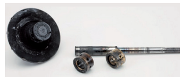
Figura 2: Eje del rotor roto debido a una lubricación deficiente de los cojinetes radiales
