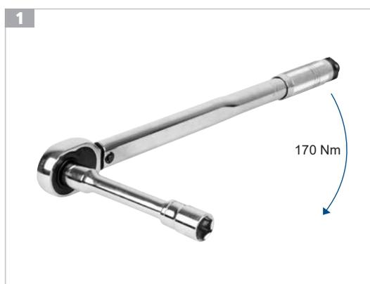
**EN** Step 1: Torque 170 Nm
