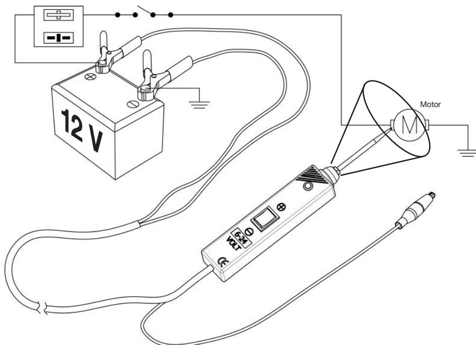
Tipp: Sie können die Lebensdauer Ihres Prüfgerätes HAZET 2152-5 verlängern, wenn Sie beim Prüfen von Komponenten zuerst den Wippschalter betätigen und dann die Prüfspitze an die Komponente führen. Die Lichtbogenbildung erfolgt dann an der Prüfspitze und nicht an den Schalterkontakte.
