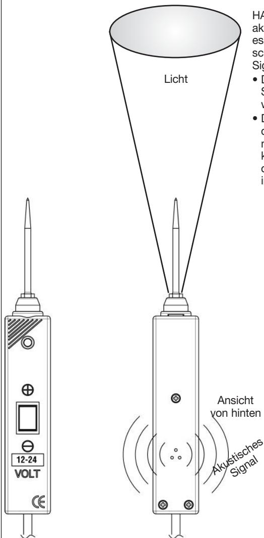
HAZET 2152-5 ist mit Beleuchtung und einer akustischen Signalfunktion ausgestattet. Wenn es an eine funktionstüchtige Batterie angeschlossen wird, werden Beleuchtung und Signalfunktion aktiviert.
