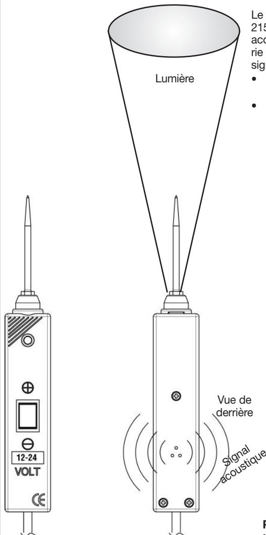
Le testeur électronique multifonctionnel HAZET 2152-5 est équipé d'un éclairage et d'un signal acoustique. Lorsqu'il est connecté à une batterie fonctionnelle, l'éclairage et les fonctions du signal acoustique sont activés.
