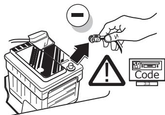
(DE) Um Störungen und Schäden am Bordnetz zu vermeiden, muss die Massenpolklemme unbedingt vor Beginn aller Arbeiten von der Fahrzeugbatterie getrennt werden! Insbesondere bei Arbeiten und Anschlüssen am CAN-Datenbus kann bei nicht abgeklemmter Batterie sowohl das Anhängermodul als auch das fahrzeuseigene Bordnetzsteuergerät beschädigt werden! Bitte Herstellervorschriften beim Ab- und Anklemmen der Fahrzeugbatterie beachten!
